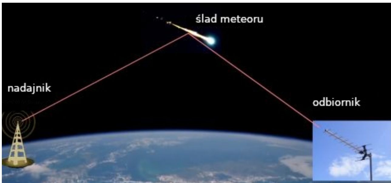
Rys. 3. Schemat zjawiska odbicia fali radiowej od śladu plazmowego po meteorze. Źródło: livemeteors.com
