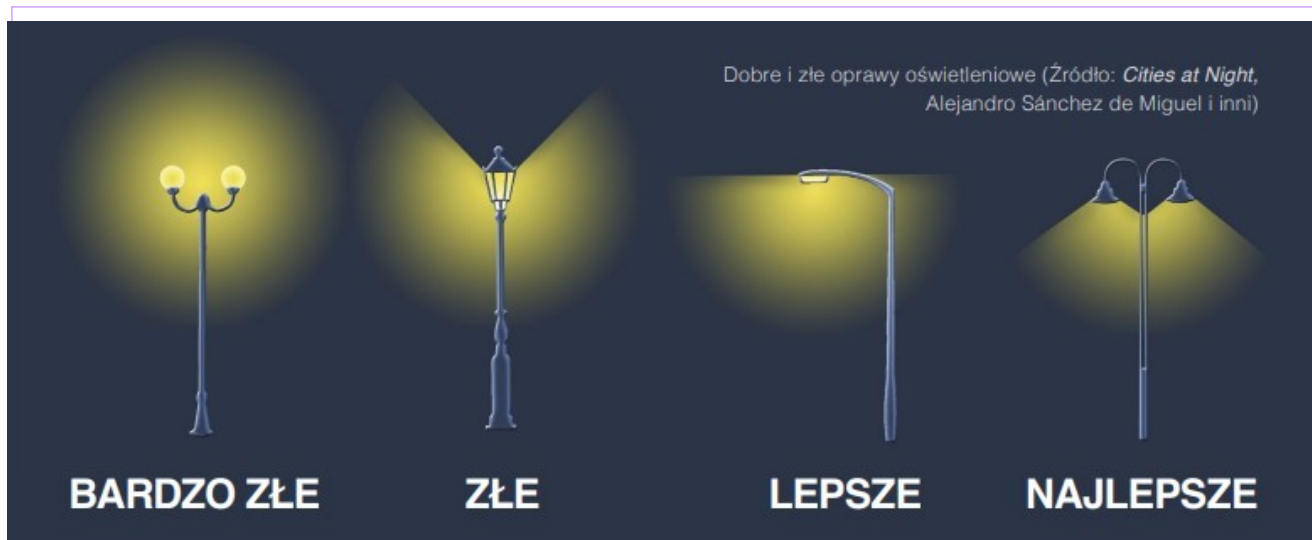
Rysunek 3. Przykłady prawidłowego i nieprawidłowego oświetlenia miejskiego.
