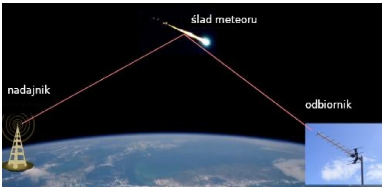
Rys. 3. Schemat zjawiska odbicia fali radiowej od śladu plazmowego po meteorze. Źródło: livemeteors.com
